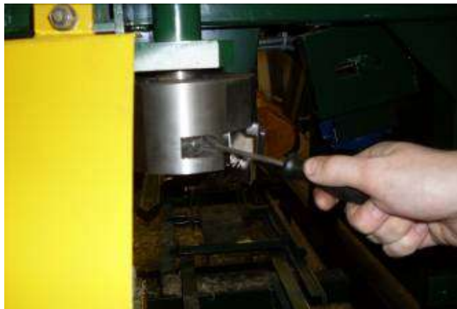
Рисунок 16. Регулировка чашкорезной фрезы
