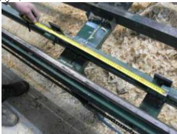
Рисунок 20. Указываем места фрезерования чаш
