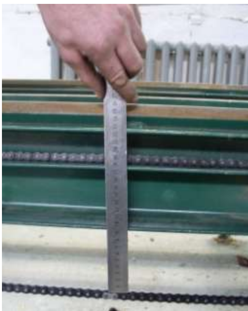
Рисунок 5. Измерение расстояния между верхней и нижней веткой цепи
