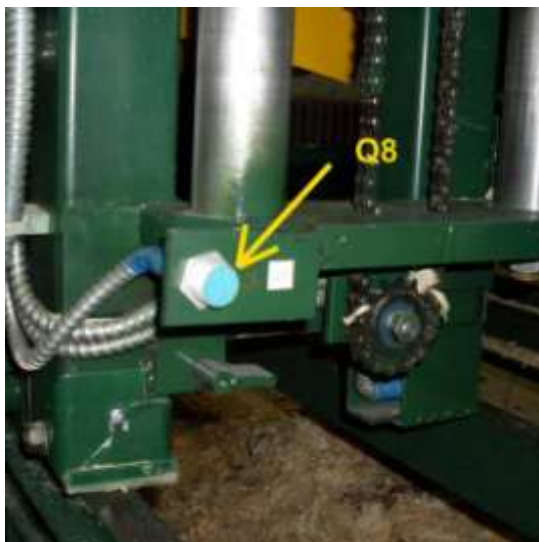
Рисунок 38. Расположение индукционных датчиков положения.
