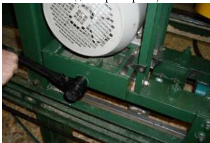
Рисунок 11. Регулировка фрезы оцилиндровки
