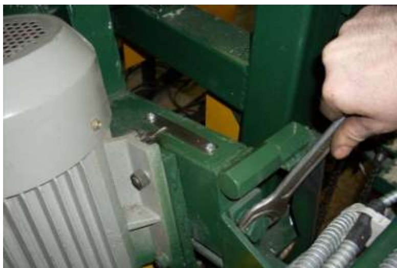
Рисунок 13. Регулировка фрезы монтажного паза
